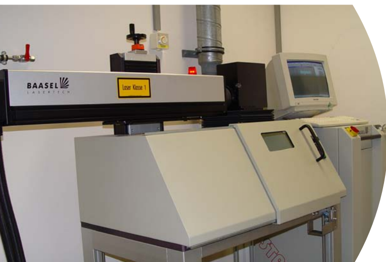
Abb. 13: Nd: YAG-Beschriftungslaser 1064 nm (Fa. Baasel-Lasertechnik)
