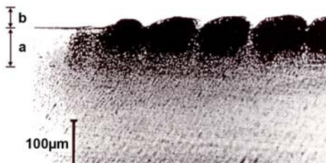
Abb. 18: Charakterisierung der Laserbeschriftung durch Beurteilung von Verfärbungstiefe (a) und Aufschäumhöhe (b)
