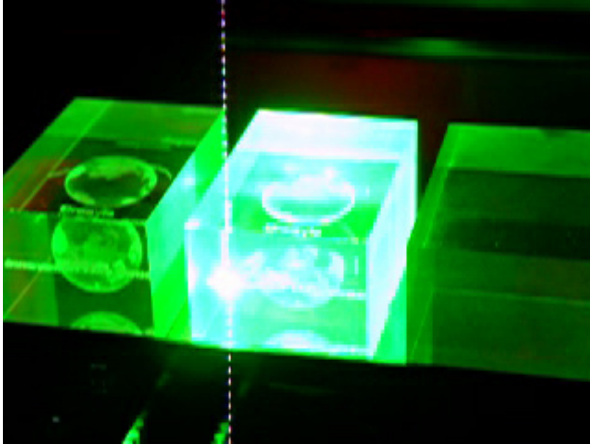
Abb. 25: 3D-Lasermarkierung von PLEXIGLAS® (PMMA)
