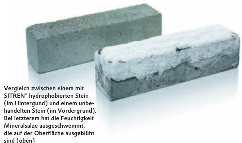
Vergleich zwischen einem mit SITREN® hydrophobierten Stein (im Hintergrund) und einem unbehandelten Stein (im Vordergrund). Bei letzterem hat die Feuchtigkeit Mineralsalze ausgeschwemmt, die auf der Oberfläche ausgeblüht sind (oben)
