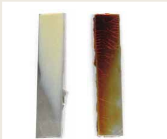
Abbildung 4: Rissbildung von VESTOPLAST® (links) und Blockcopolymer basierten Formulierungen (rechts)
