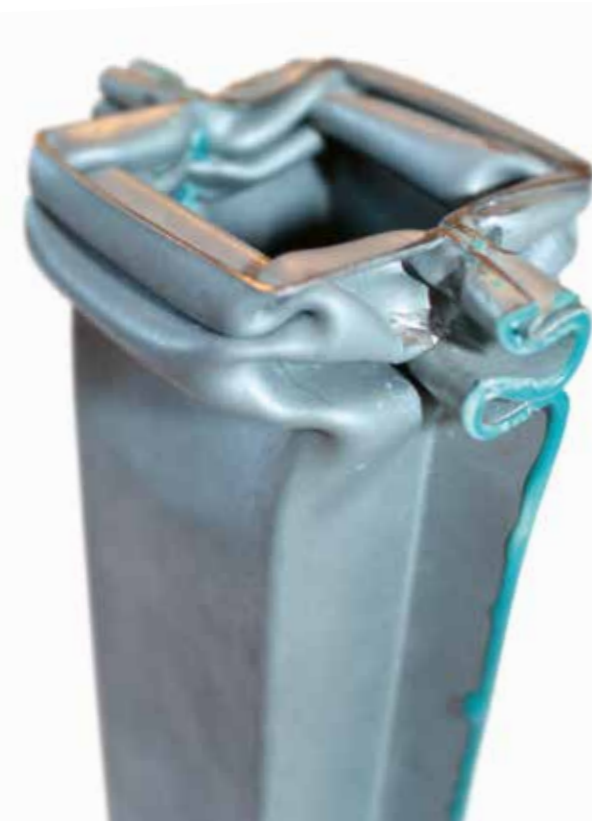
Abbildung 1: Doppelhutprofil-Prüfkörper, mit dem Automobilklebstoffe auf ihr Crashverhalten getestet werden
