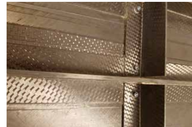
Abbildung 2: Einsatz eines Strukturklebstoffes auf der Innenseite der Tragfläche des Airbus A 380
