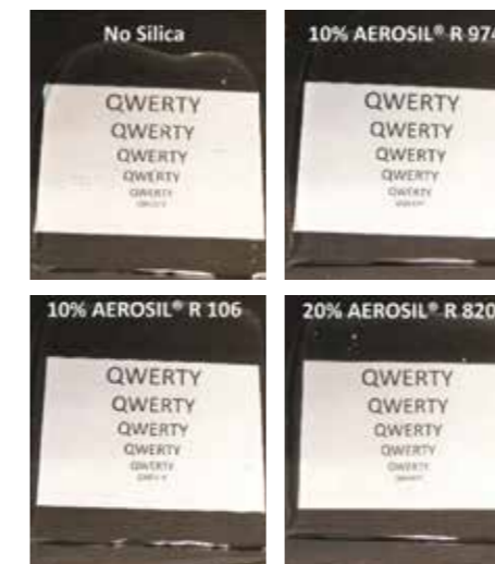
Transparente STPU-Dichtstoffe, die mit jeweils 10 Gew.-% AEROSIL® R 974 oder AEROSIL® R 106 bzw. 20 Gew.-% AEROSIL® R 8200 gefüllt waren, im Vergleich zur Nullprobe ohne AEROSIL® (vgl. Rezeptur 1).
