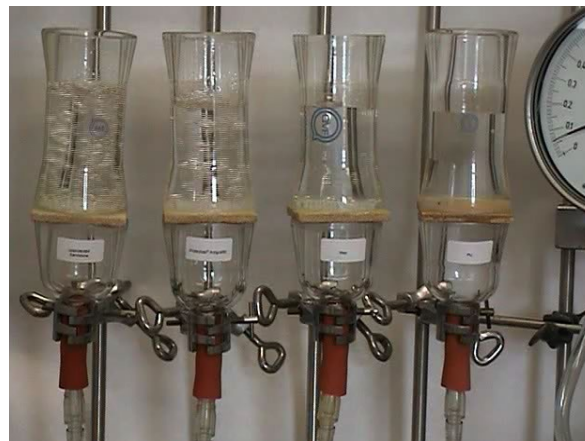
Kontrolle Protectosil ANTIGRAFFITI® Wachs Beschichtung
