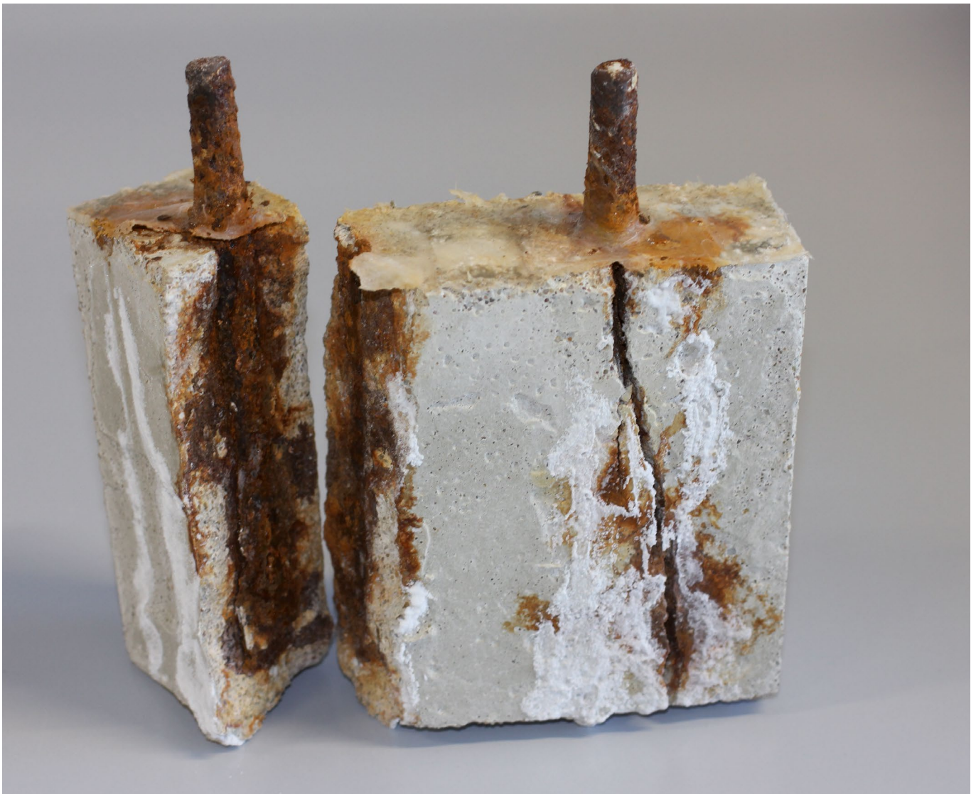
Schadensbild eines ungeschützten Probekörpers
