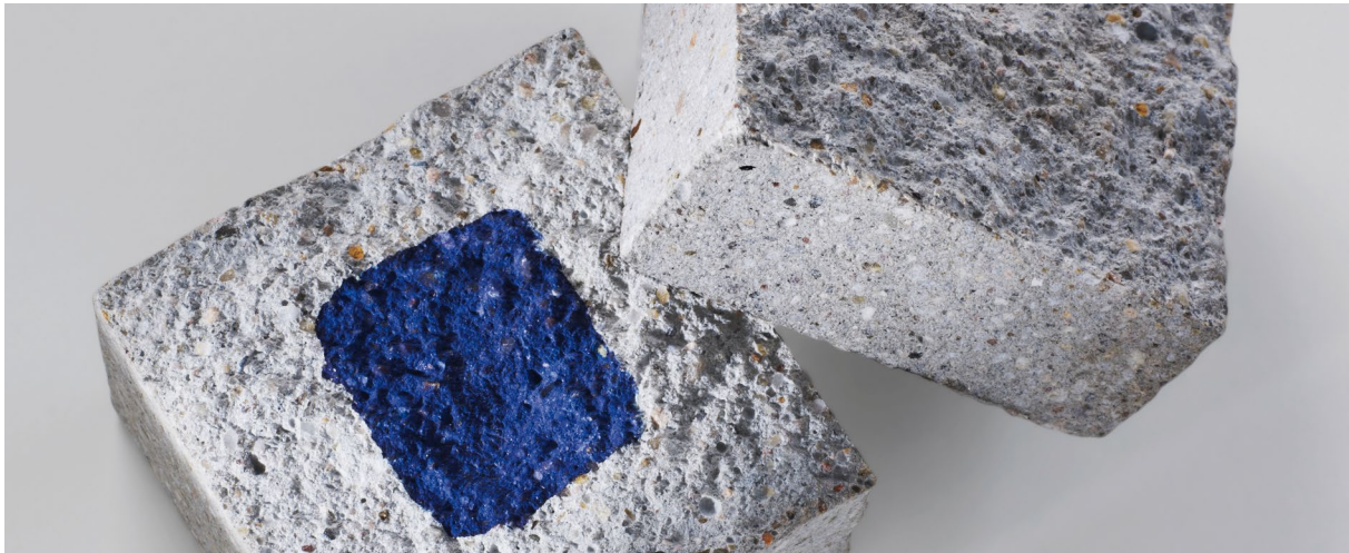
Das tief in den Baustoff eingedrungene Protectosil® Hydrophobierungsmittel baut eine Schutzwirkung auf, die Wasser abweist
