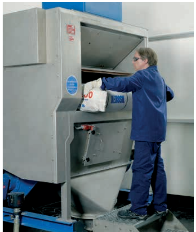
Abbildung 5 Halbautomatische Sackentleeremaschine (Hersteller: Dinnissen B. V, 5975 NB Sevenum, Holland)
