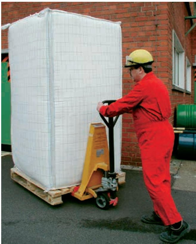
Abbildung 2 Beispiel für einen FIBC (Flexible Intermediate Bulk Container)
