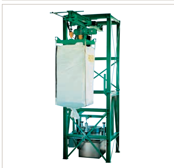
Abbildung 7 Entleerung von Fällungskieselsäure aus einem FIBC (Hersteller: Hecht Technologie GmbH, 85276 Pfaffenhofen)
