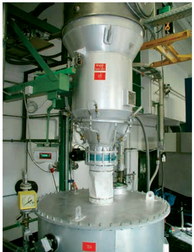
Abbildung 27 Behälterwaage zur chargenweisen Dosierung von synthetischen Kieselsäuren
