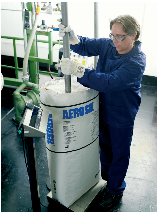
Abbildung 29 Differenzwägung durch Herausaugen der synthetischen Kieselsäure aus einem Sack
