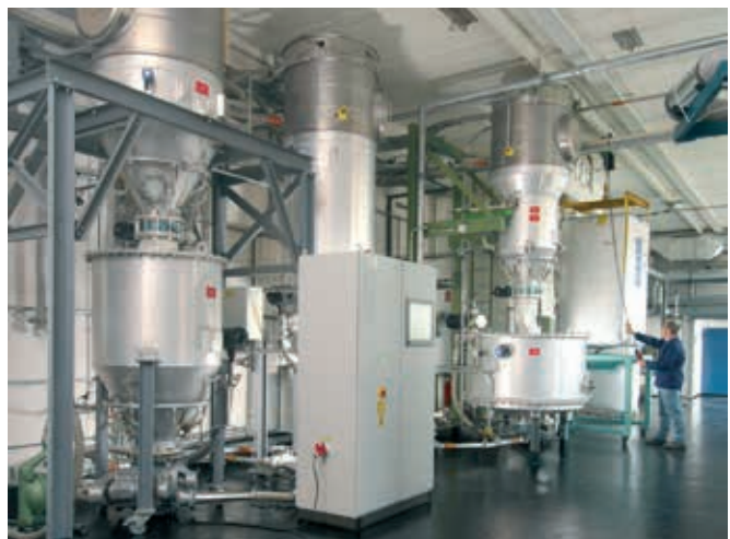
Abbildung 10 Saugpneumatische Versuchsförderanlage im Handhabungstechnikum bei Evonik in Hanau
