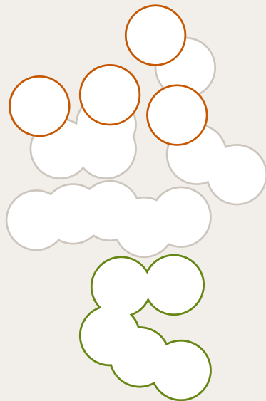
Abbildung 3: Schematische Darstellung zur Erläuterung der Begriffe Primärteilchen, Aggregate und Agglomerate
