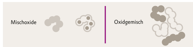
Abbildung 9: Vergleich von Mischoxiden und Oxidgemischen
