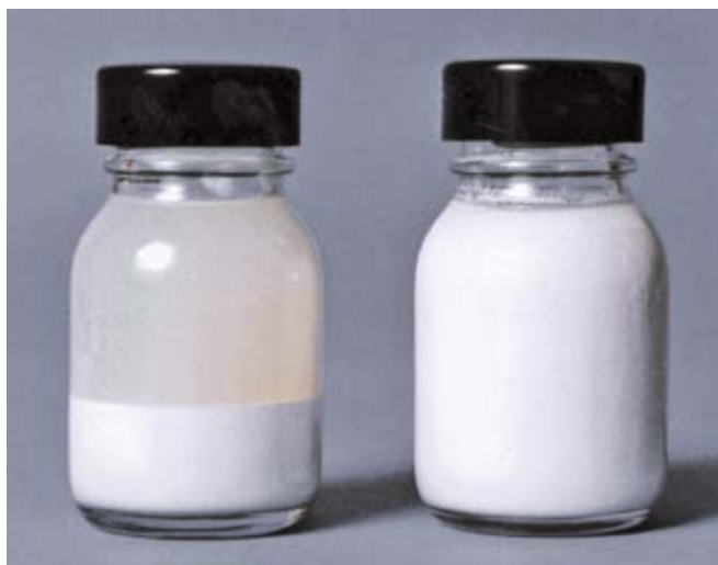
Abbildung 80: Separation nach 8 Wochen Lagerung bei Raumtemperatur Links: ohne AEROSIL®, rechts: 0,8% AEROSIL® R 972 Wasserbasierter Füller auf Basis PUR-Dispersion/Melaminharz
