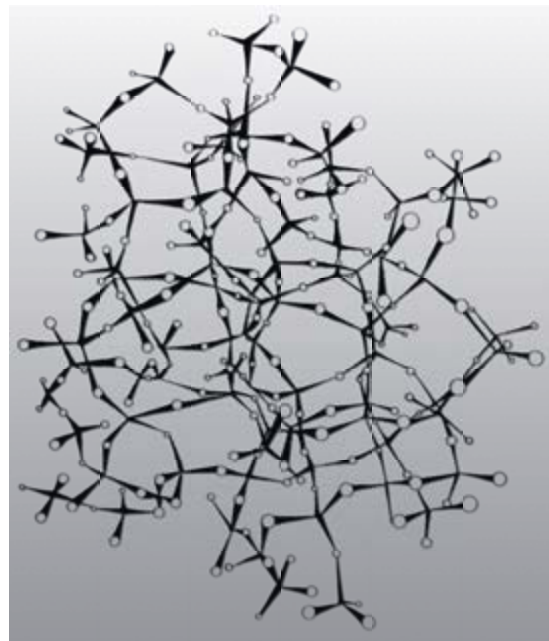
Abbildung 31: Schematische Anordnung der \text{SiO}_4 -Tetraeder in AEROSIL® nach einem Modell von EVANS und KING [10]. Die Kreise symbolisieren Sauerstoffatome; in den Zentren der Tetraeder sitzen die Siliciumatome
