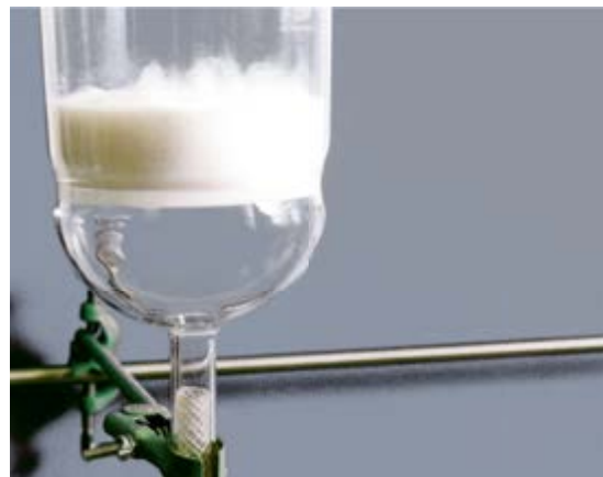
Abbildung 33: Einfache Labordemonstration zur Fluidisierung von AEROSIL®. An der Glasfritte liegt Druckluft von etwa 0,2 bar
