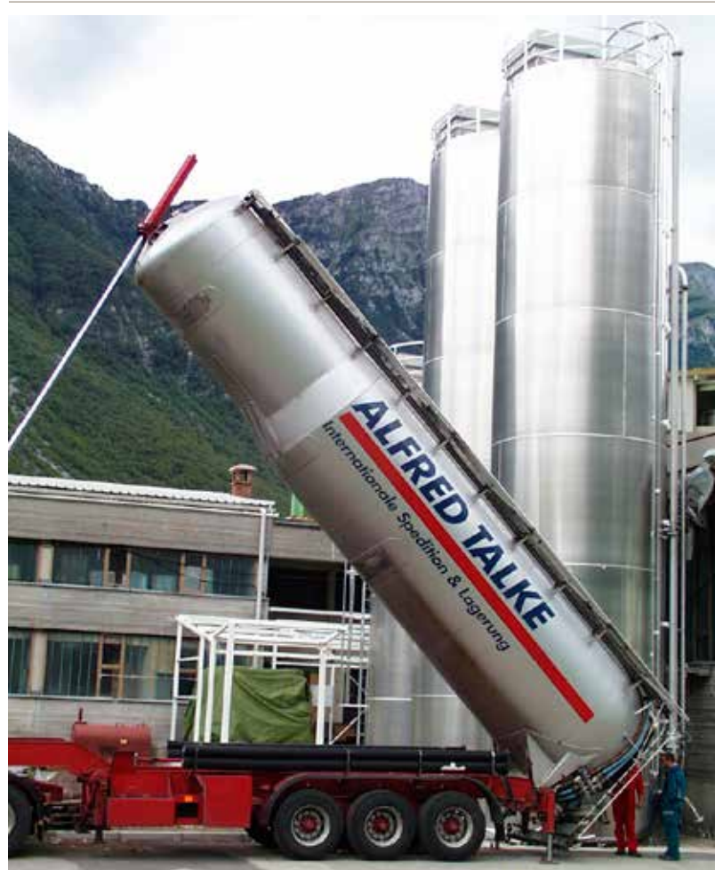
Abbildung 5 Lagerung von AEROSIL® im Lagersilo
