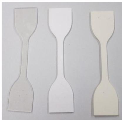
Prüfkörper ohne (links) und mit Hitzestabilisierungsadditiv (Mitte und rechts)
