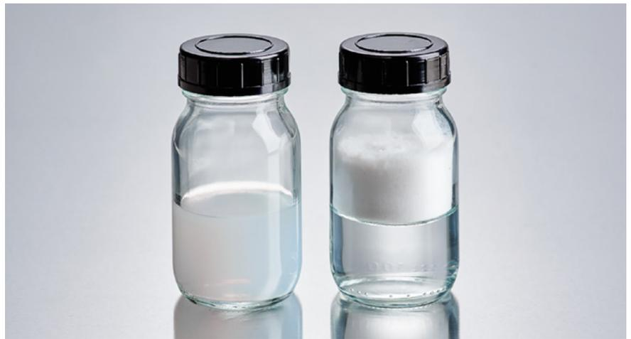
Wasser mit hydrophilem (links) und hydrophobem (rechts) pyrogenem Metalloxid
