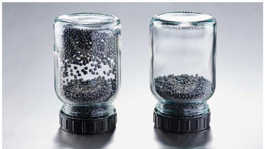
Polypropylengranulat ohne (links) und mit 0,5% AEROXIDE® Alu C.
