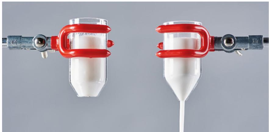
Fließeigenschaften von AEROXIDE® TiO<sub>2</sub> P 25 (links) und VP AEROPERL® P 25/20 (rechts)
