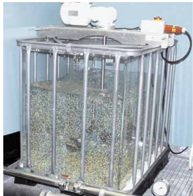
Abbildung 11 Viscojet während der Dispergierung
