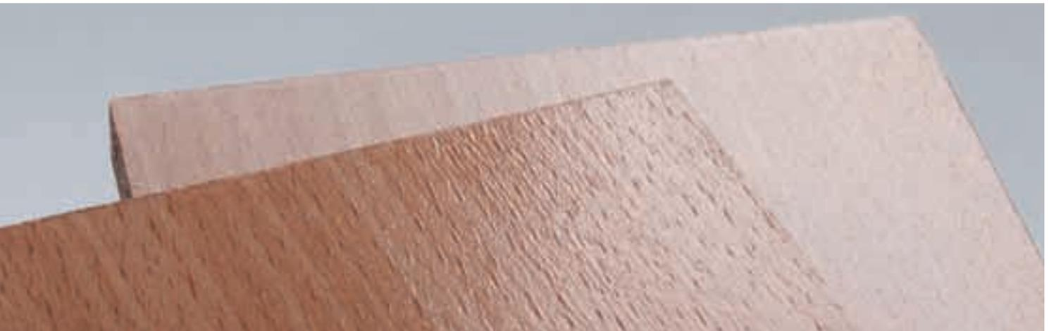
Abbildung 2: Wässrige, airless applizierte Holzlackbeschichtung
