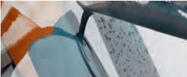
auf das gefüllte Ochsenauge und stellt diese Anordnung auf den Kopf, so dass die Kupfersulfatlösung einwirken kann. Nach 24 Stunden wird die Lackoberfläche mit Wasser abgespült. Sind feine Poren in der Beschichtung, zeigen sich rote Punkte. Dabei handelt es sich um elementares Kupfer, das aus der Kupfersulfatlösung abgeschieden wurde, während Eisen aus dem Blech in die Lösung gegangen ist.
