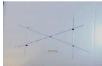
ANCAMIDE® 2832 EPOXY PRIMER + POLYCARBAMIDE TOPCOAT Crosshatch adhesion
