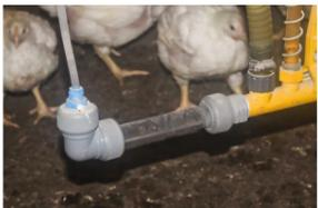
Am Sichtrohr wird visuell die Bildung von Biofilm verfolgt und in drei Transparenz Stufen eingeteilt
